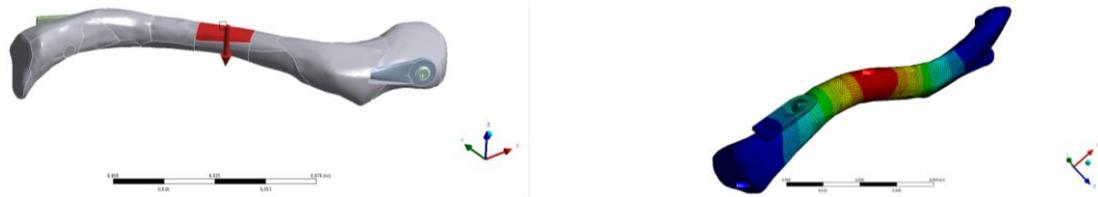
Рисунок 4 – Исследование прочностных характеристик моделей ключицы при внутрикостной фиксации в условиях нагрузки во фронтальной плоскости
