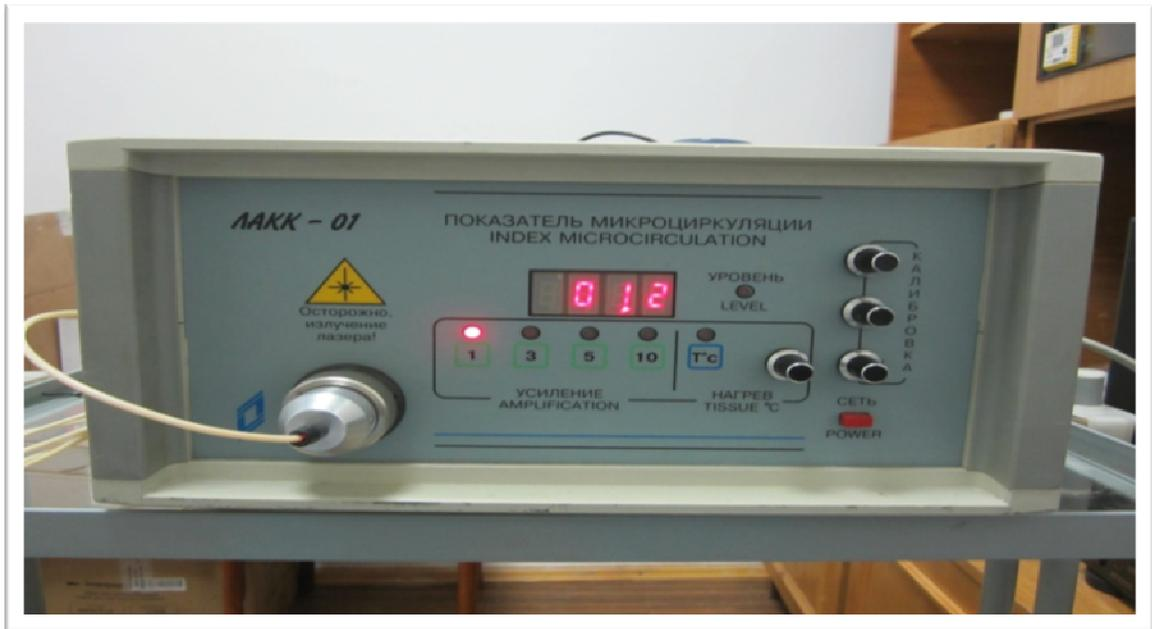
Рисунок 7 - Лазерный анализатор капиллярного кровотока (ЛАКК-01).
