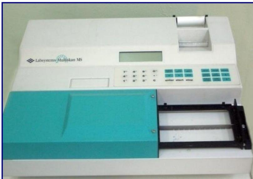
Рисунок 5 – Спектрофотометр LabSystems Multiskan MS.
