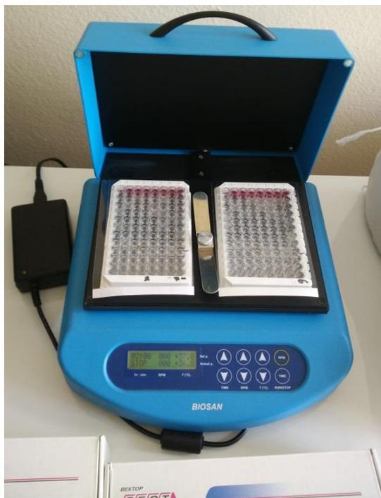
Рисунок 4 – Термошейкер PST-60HL-4 (BIOSAN, Латвия).
