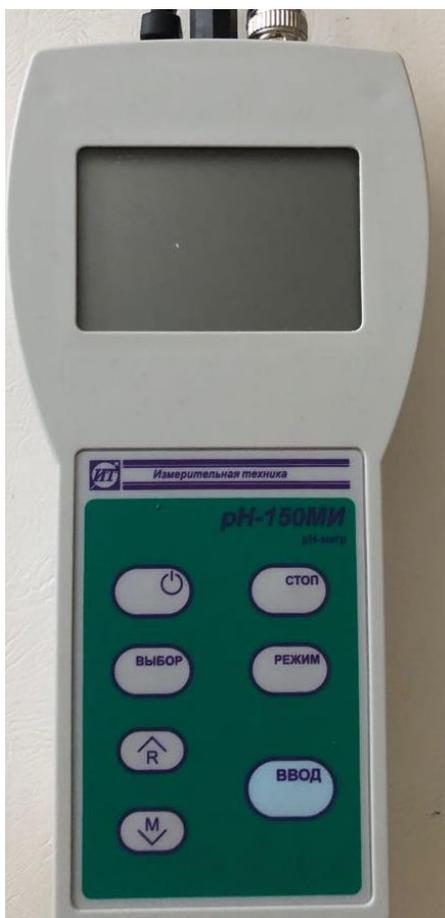
Рисунок 2 - pH-метр – ацидометр микропроцессорный PH-150МИ.
