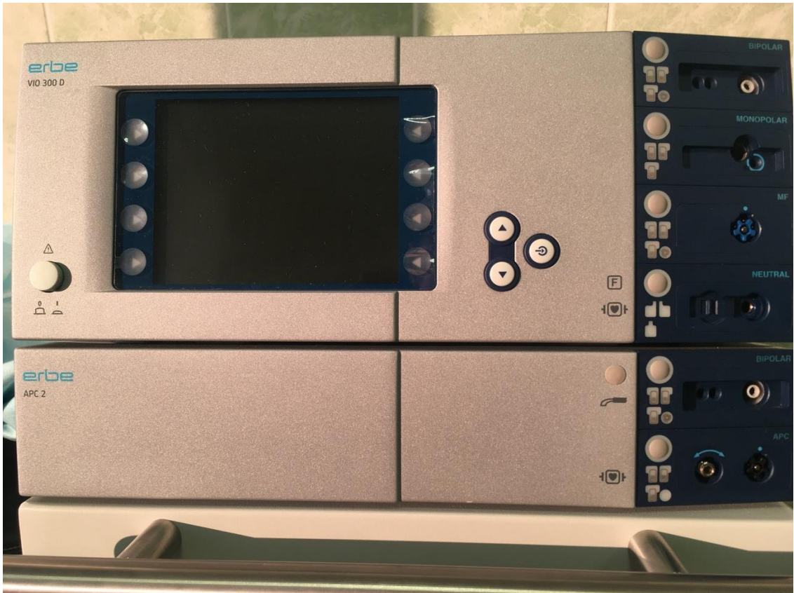
Рисунок 9 – Электрохирургический высокочастотный прибор Erbe Vio 300D (Германия) с блоком аргонплазменной коагуляции APC 2
