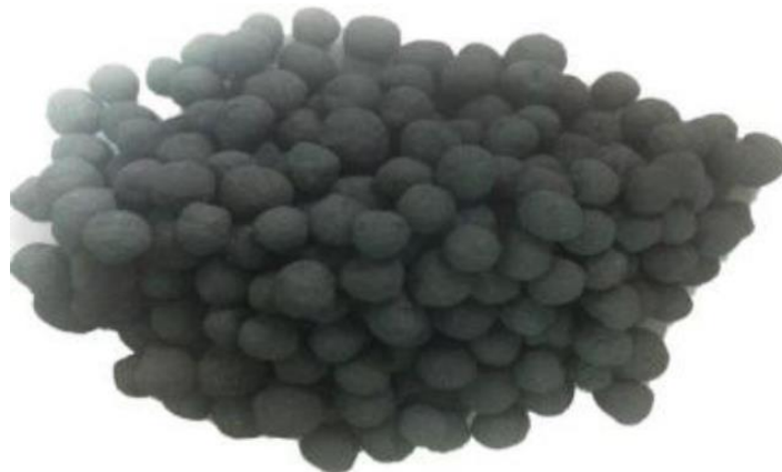
Рисунок 7 - Железорудные окатыши, выпущенные с вводом марганцовистого известняка.
