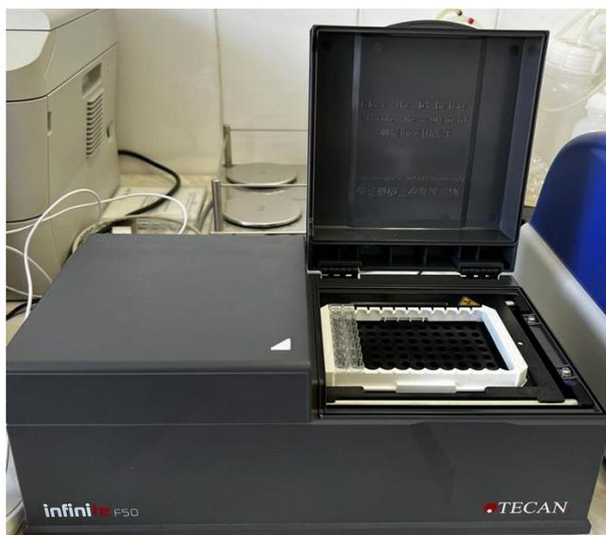
Рисунок 6 – Анализатор иммуноферментный микропланшетный «Infinite F50».
