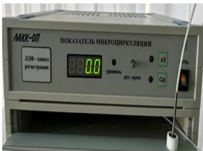
Рисунок 18 – Прибор лазерной доплеровской флоуметрии ЛАКК–ОП.
