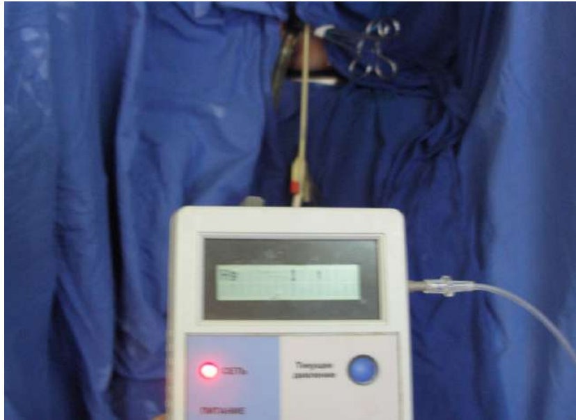
Рисунок 5 - Измеритель инвазивный низких давлений ИиНД 500/75 «Тритон».
