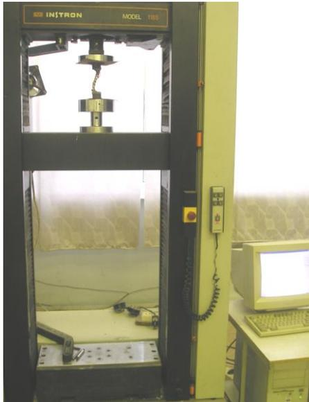
Рисунок 2.1 - Расположение системы кость-имплантат-кость при стендовых испытаниях в динамометре INSTRON 1185.
