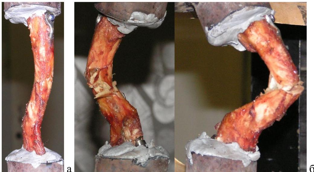
Рисунок 4.15 - Исследование прочностных свойств образца ключицы, синтезированной блокируемым стержнем оригинальной конструкции; а - вид образца до испытания, б - вид образца после стенового испытания.
