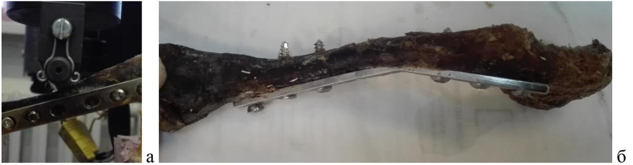
Рисунок 4.26 -Исследование прочностных свойств образца ключицы, синтезированного прямой пластиной при нагрузке в сагиттальной плоскости (спереди-назад); а - вид образца до испытания, б - вид образца после стендового испытания.
