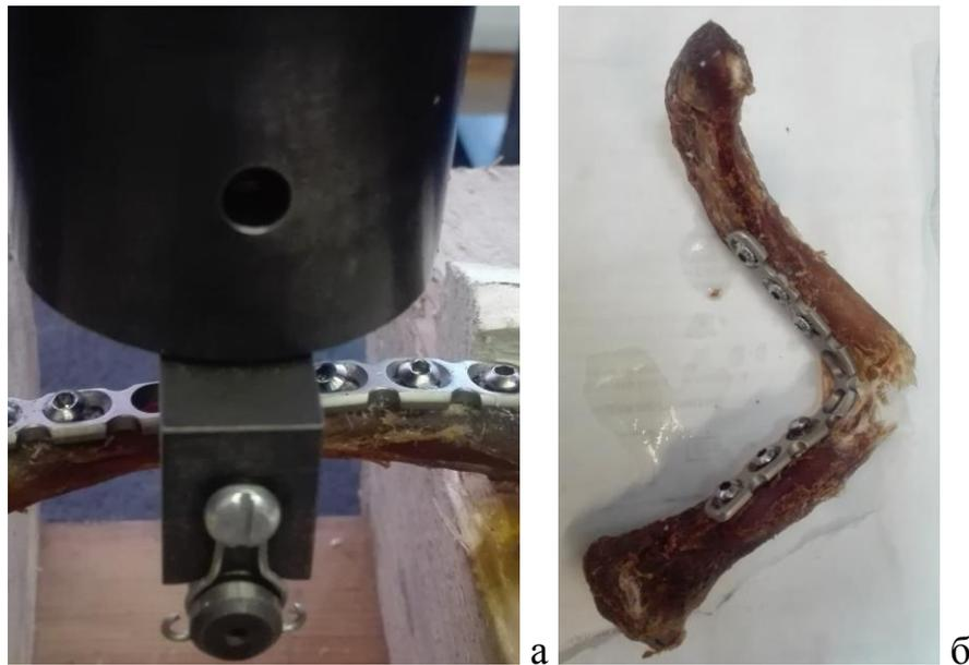
Рисунок 4.29 - Исследование прочностных свойств образца ключицы, синтезированного реконструктивной пластиной (толщина 2,3мм) при нагрузке во фронтальной плоскости (сверху-вниз); а - вид образца до испытания, б - вид образца после стендового испытания.
