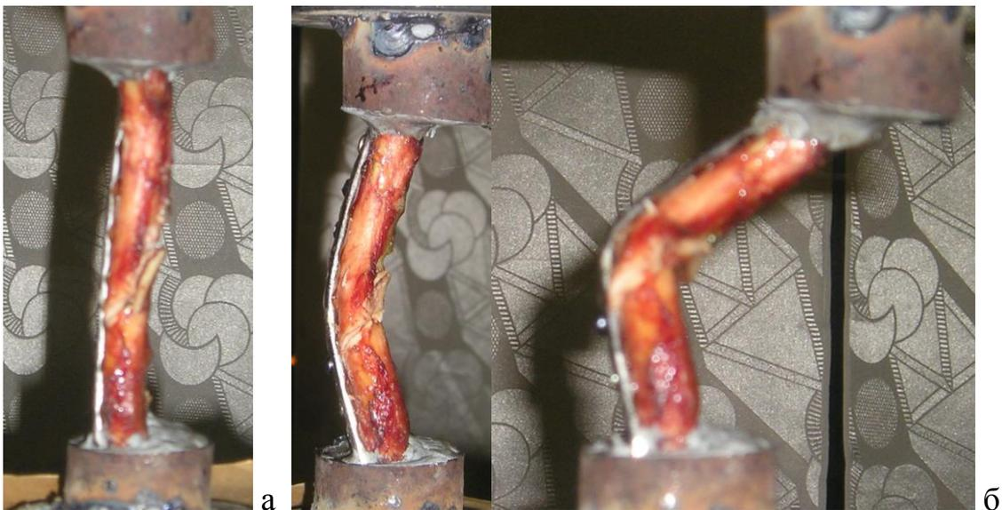
Рисунок 4.17 - Исследование прочностных свойств образца ключицы, синтезированной пластиной с угловой стабильностью; а - вид образца до испытания, б - вид образца после стендового испытания.
