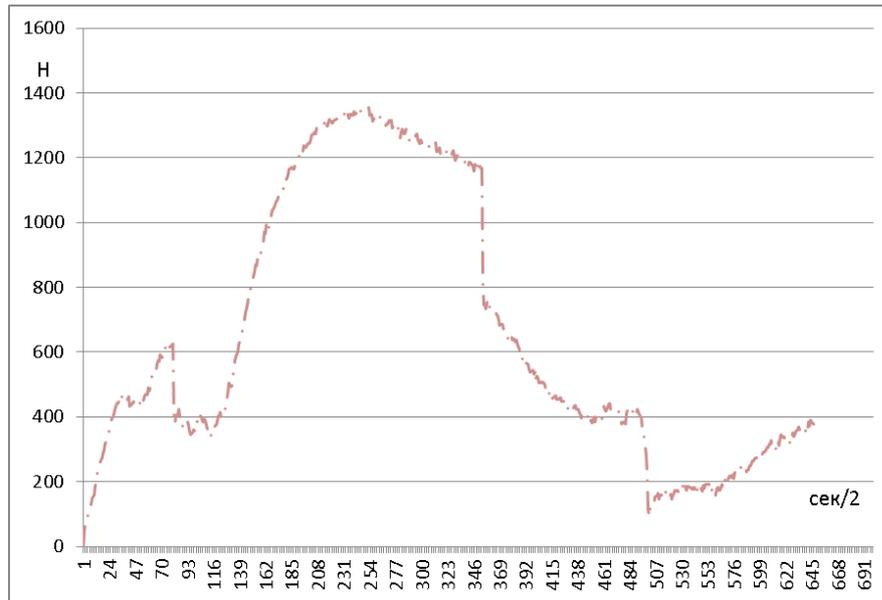
Рисунок 4.22 - График разрушения образца ключицы, синтезированной внутрикостным стержнем без блокирования (3,5x4,5 мм)
