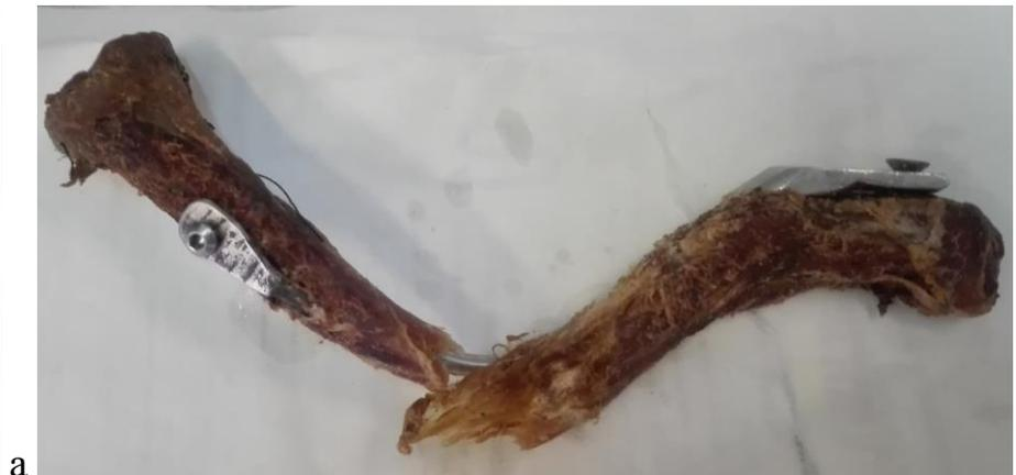
Рисунок 4.23 - Исследование прочностных свойств образца ключицы, синтезированной блокируемым стержнем оригинальной конструкции при нагрузке в сагиттальной плоскости (спереди-назад); а - вид образца до испытания, б - вид образца после стендового испытания.
