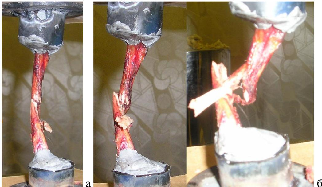
Рисунок 4.19 - Исследование прочностных свойств образца ключицы, синтезированной внутрикостным стержнем без блокирования (2x3 мм); а - вид образца до испытания, б - вид образца после стендового испытания.
