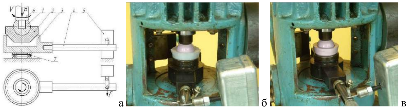
Рисунок 6.19. Схема работы и общие виды ЧМТ-1 при исследовании эндопротезов на модернизированной четырехшариковой машине трения (ЧМТ-1); 1 – головка эндопротеза; 2 – вкладыш эндопротеза; 3 – чаша; 4 – рычаг; 5 – датчик фиксирования силы трения F ; 6 – приводной вал; 7 – упорный подшипник качения; а – схема работы ЧМТ-1; б – исследование пары трения АКер-Пол; в – исследование пары трения АКер-АКер
