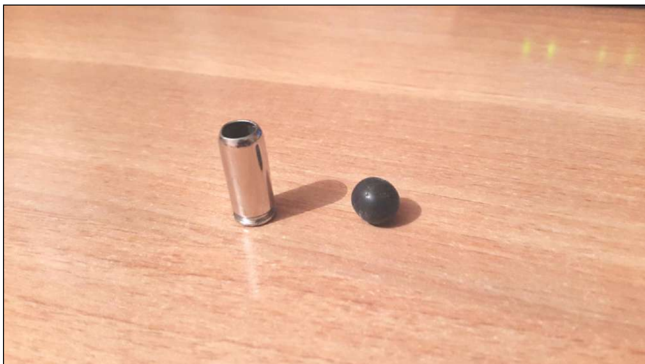
Рисунок 3 – Латунная гильза и резиновый снаряд (пуля) калибра 9 мм
