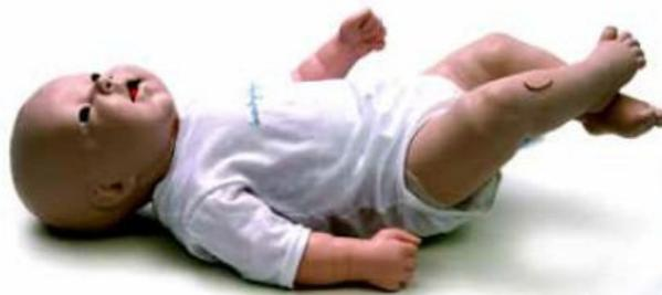
Робот-симулятор БэбиСИМ представляет собой высокотехнологичную компьютеризированную модель шестимесячного младенца. Робот автоматически воспроизводит специфичные для младенца сердечно-легочные, метаболические, неврологические и иные физиологические реакции на врачебные манипуляции и введение лекарственных препаратов. Высокая реалистичность позволяет сократить разрыв между обучением и практикой, обеспечить наилучший перенос знаний и навыков лечения в неонатологии без риска для пациента.
