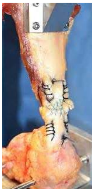
Рис.4. Ахиллово сухожилие в испытательной машине Шов Giftbox
