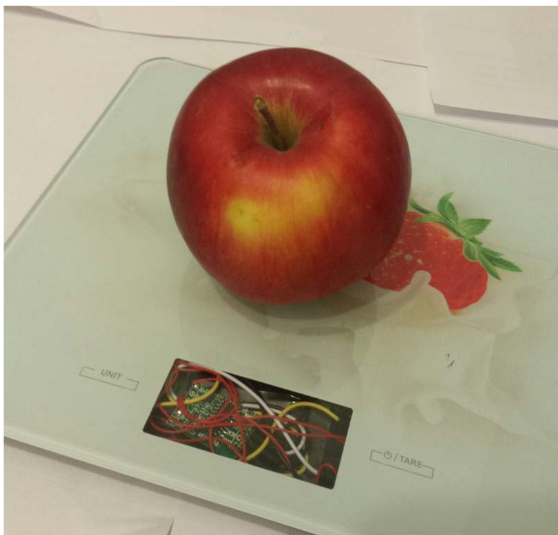
Рисунок 1. Пример: взвешивание продукта(яблоко) на электронных весах с передачей данных на компьютер.
