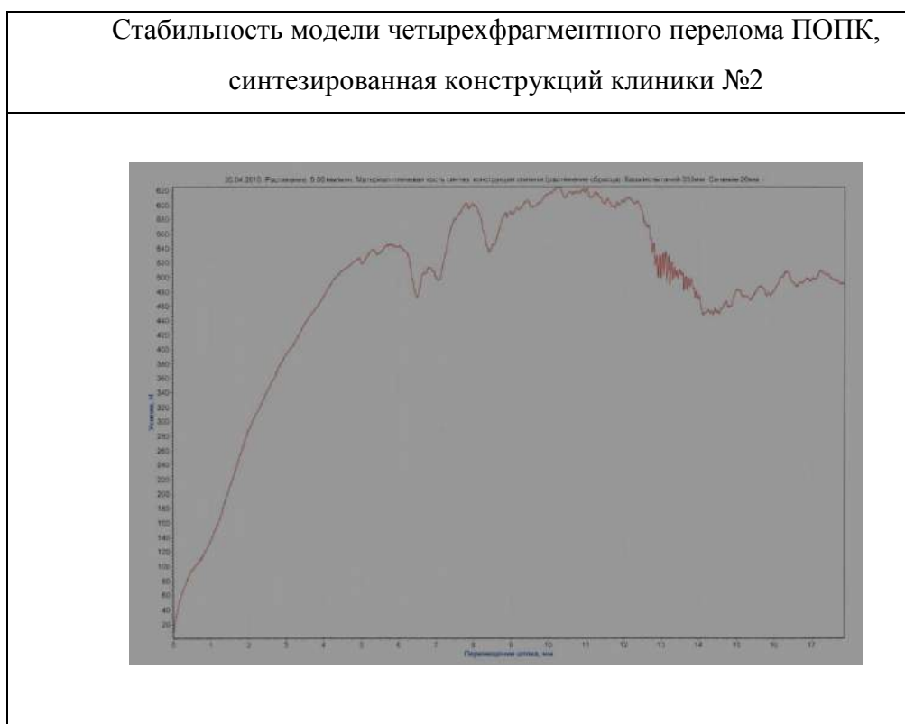
Рисунок 12. Кривая зависимости стабильности остесинтеза конструкцией клиники №2 модели четырехфрагментного перелома ПОПК от времени воздействия в режиме растяжения. Дата испытания 7.05.2010
