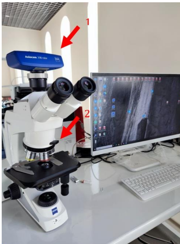
Рисунок 10 - Универсальная цифровая камера Zeiss AxioCam 208 color (1) и прямой микроскоп ZEISS AxioLab 5 для биологии (2).
