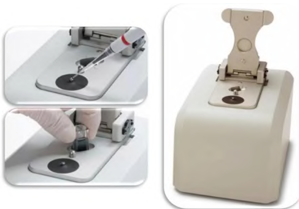
Рис. 15. Анализ качества образца ДНК при помощи спектрофотометра.
