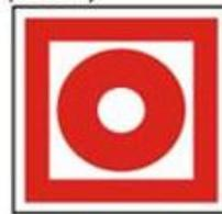
Кнопка включения установок (систем) пожарной автоматики
